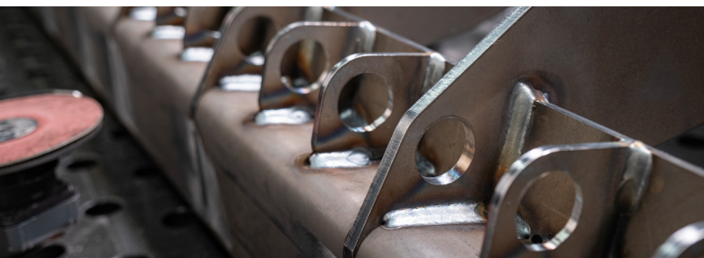
Saubere Schweißnähte dank Pulse-Schweißprozessen – eine hohe Fertigungsqualität ist bei Fliegl oberstes Gebot.
